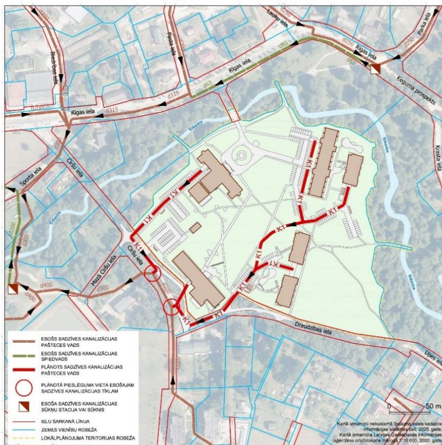
19.attēls. Principiālais centralizētās sadzīves kanalizācijas risinājums
