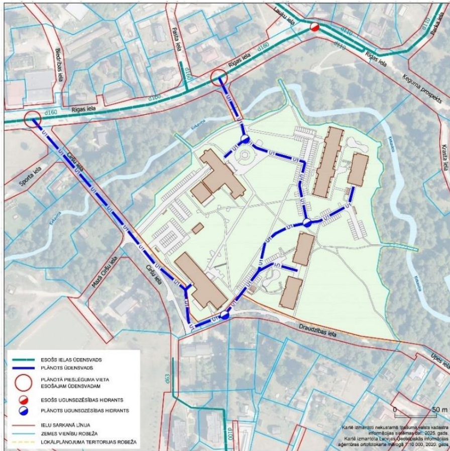
18.attēls. Principiālais centralizētās ūdensapgādes pieslēguma risinājums
