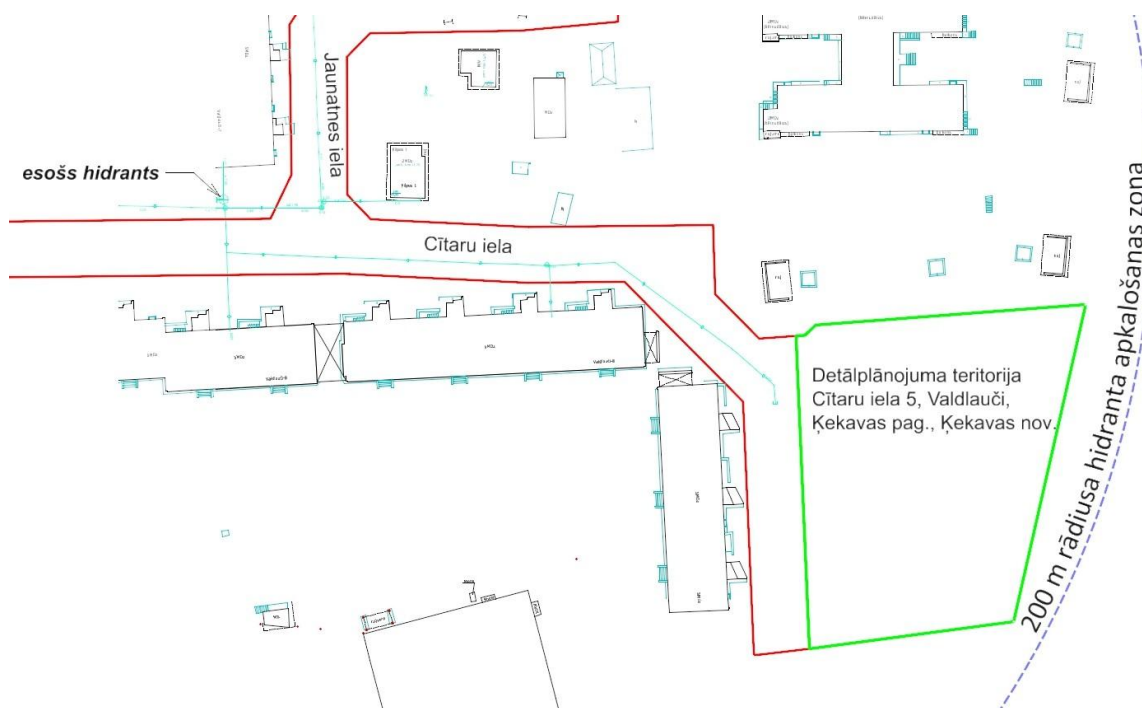
17. attēls. Hidranta izvietojums detālplānojuma teritorijai pieguļošajās teritorijās.
