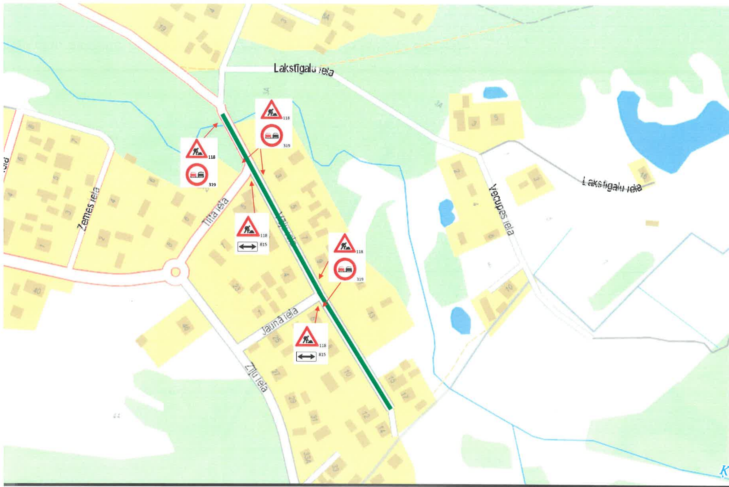
Vēju iela, Baldone. Satiksmes org. shēma būvdarbu laikā.
