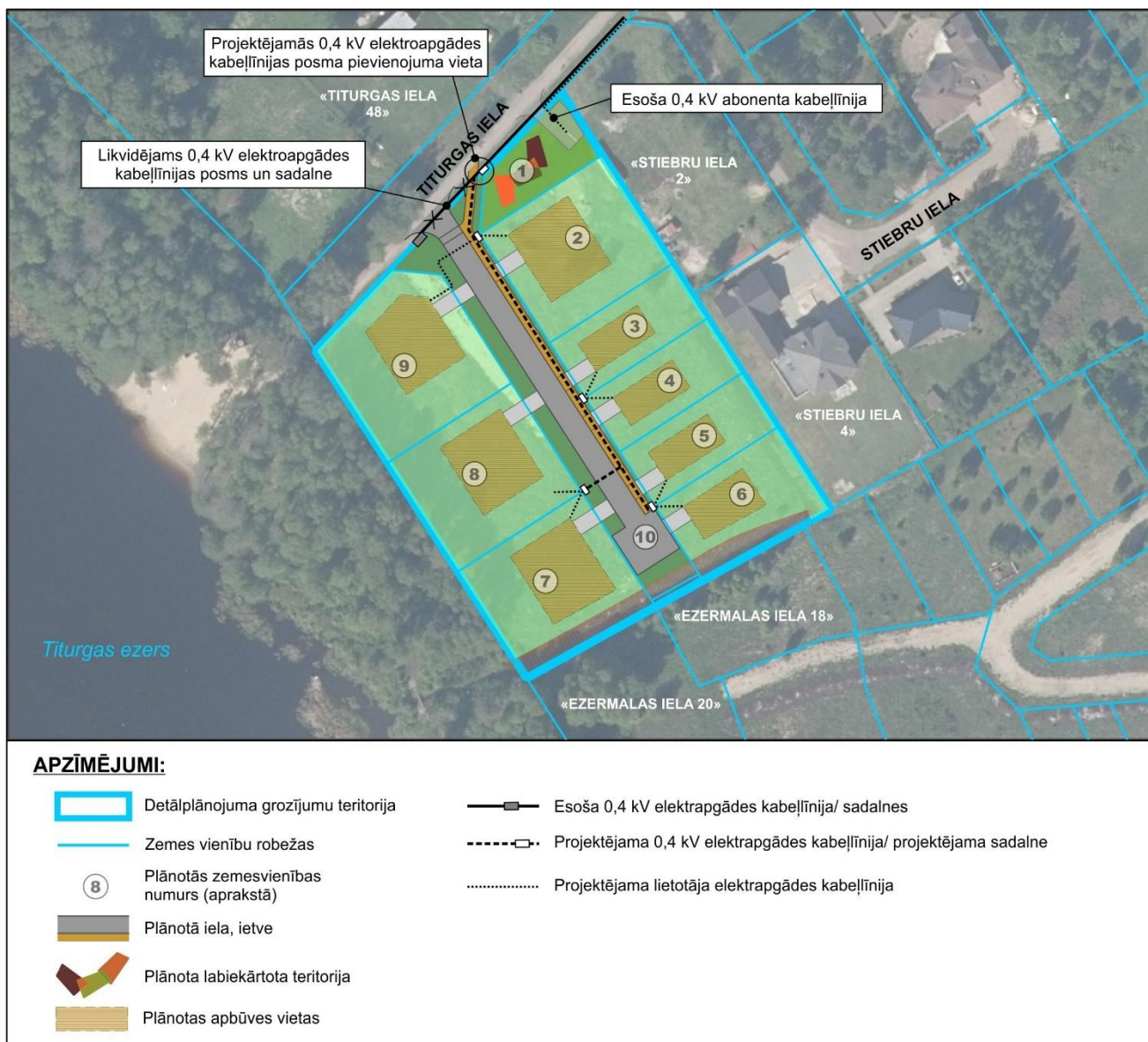
Attēls 15. Plānotā elektroapgāde
