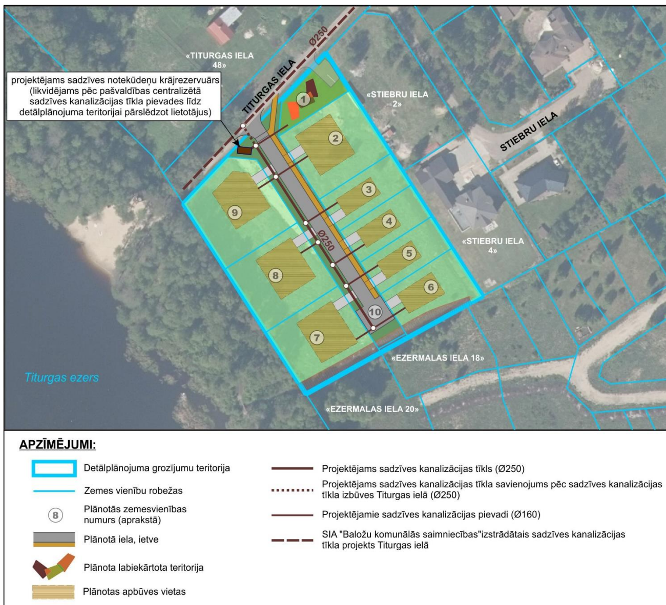
Attēls 13. Sadzīves kanalizācijas risinājuma 1.variants – centralizētas kanalizācijas sistēmas lokāls risinājums
