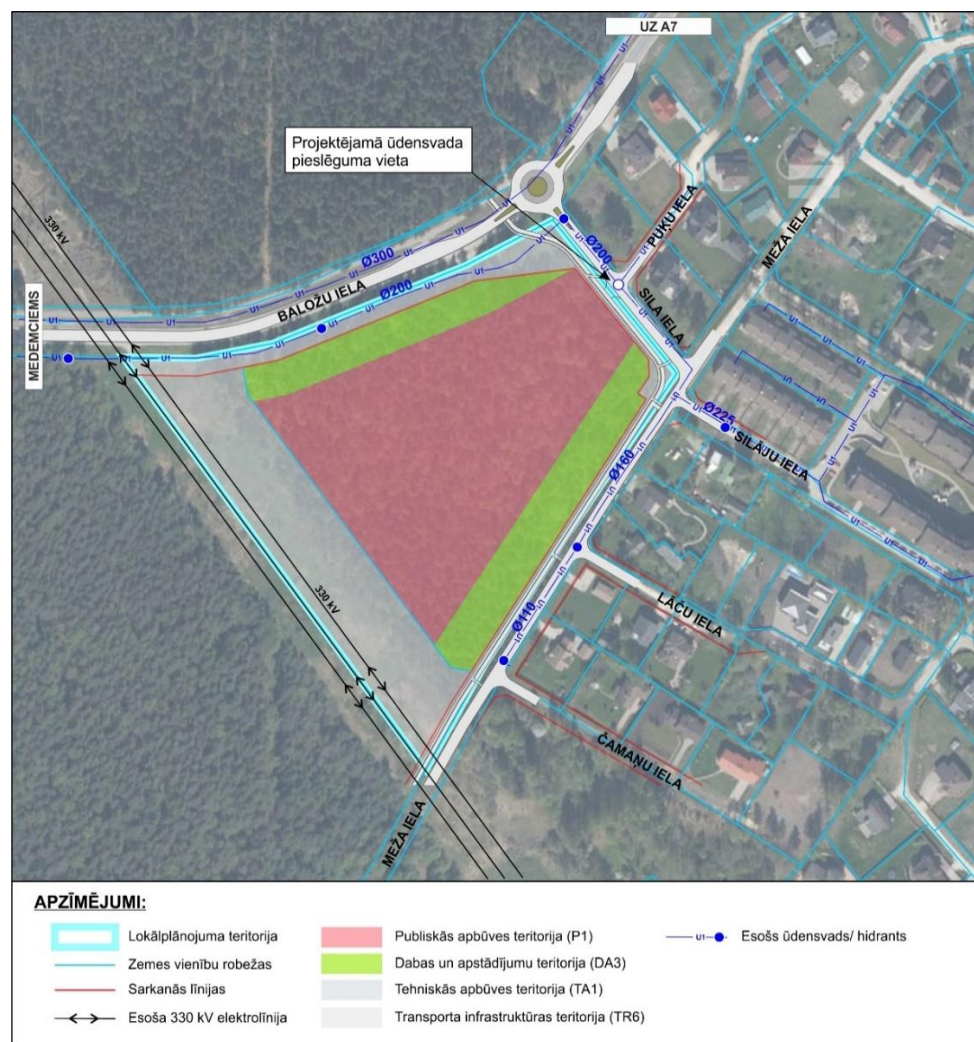
13.attēls. Ūdensapgādes shēma 27
