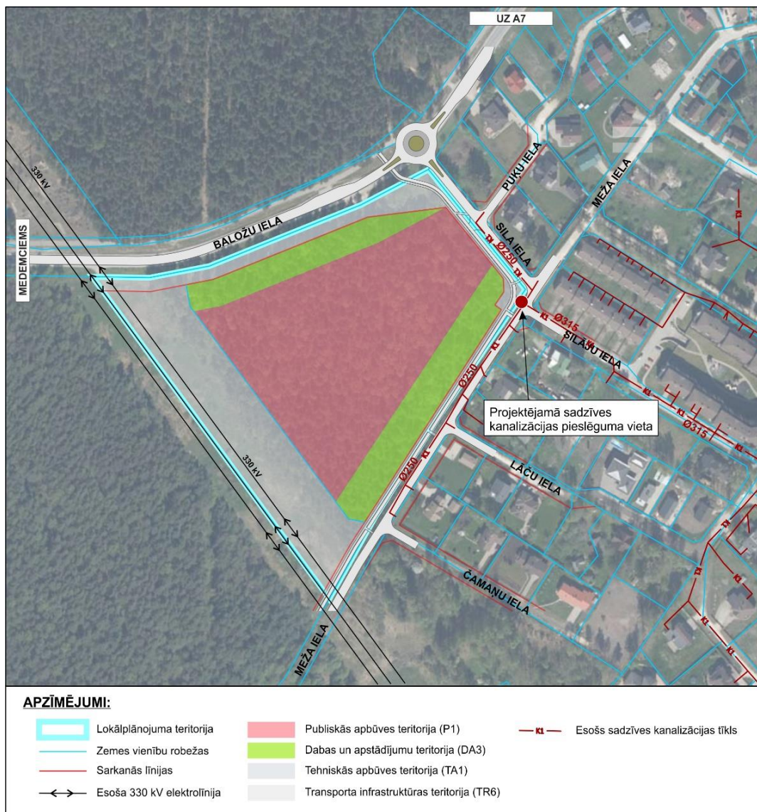
14.attēls. Sadzīves notekūdeņu kanalizācijas shēma 28
