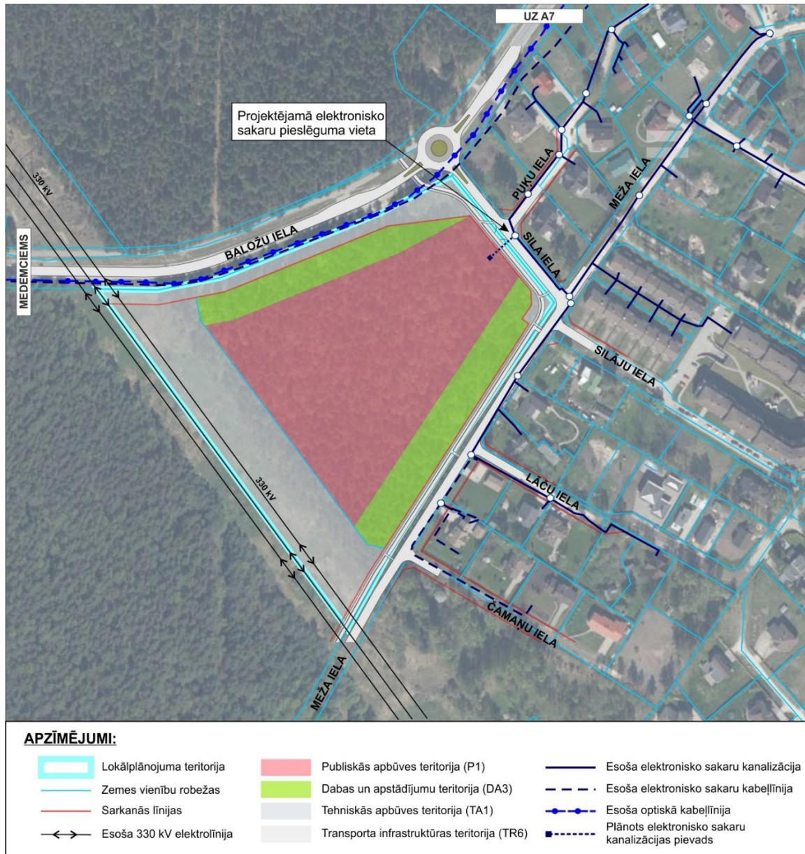
17.attēls. Elektronisko sakaru shēma 31
