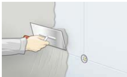
19. attēls. Armējošās javas uzklāšana uz siltumizolācijas loksniem
