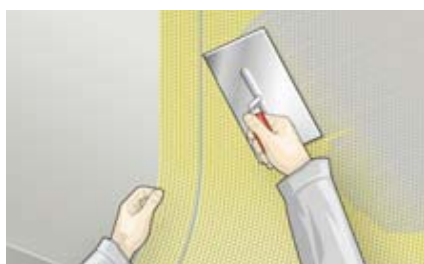
20. attēls. Armēšanas sieta iestrāde armējošajā javā
