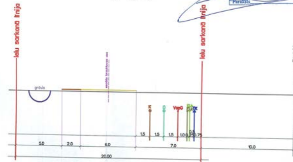
Nākotnes ielas šķēršprofils 7-7 M 1:200
