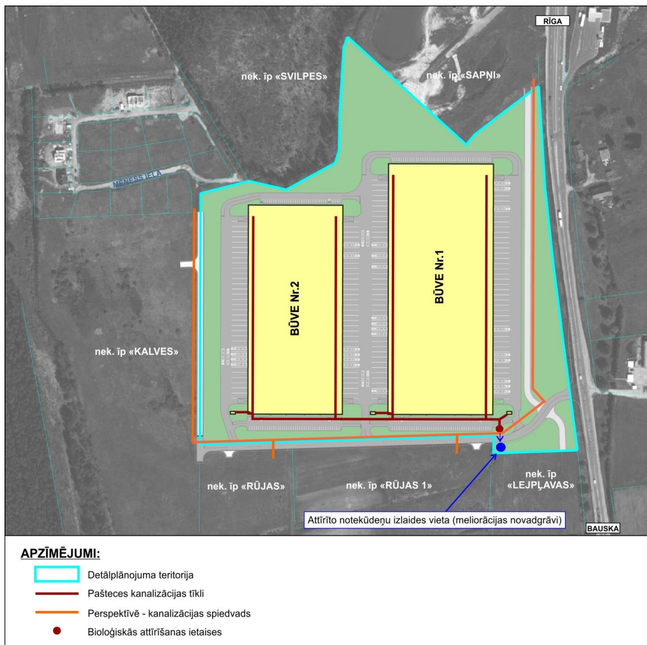
9.attēls. Notekūdeņu savākšanas risinājumi
